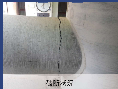
片持ち梁方式による誘導孔確認試験
