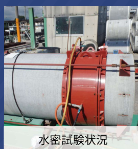
水密試験のゴムが膨張した状態
